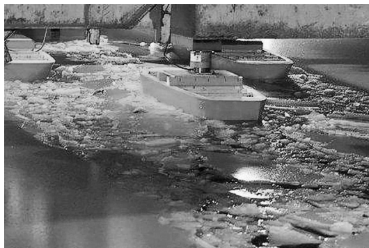
Рис. 4. Испытания модели 4-корпусного ледокола
