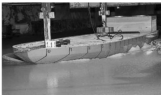
Рис. 1. Испытания модели корпуса в сплошном льду
